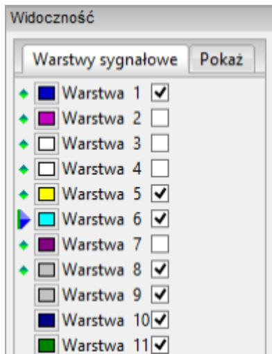
Menadżer warstw kontroluje wyświetlanie poszczególnych warstw. Strzałka wskazuje aktywną warstwę, i każda z warstw może być wyświetlona bądź ukryta przez zmianę stanu znacznika.
