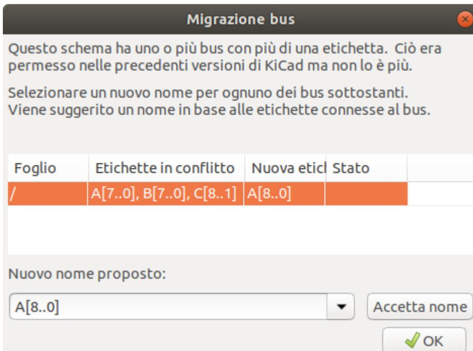
Per ogni insieme di fili di bus che ha più di una etichetta, è necessario scegliere l'etichetta da tenere. Il menu a discesa permette di scegliere tra le etichette che esistono nel progetto, oppure è anche possibile scegliere un nome ancora diverso inserendolo manualmente nel campo del nuovo nome.
